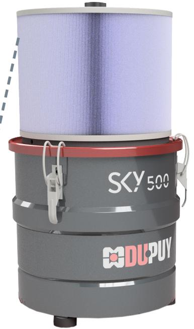
Der Sky Ölnebel-Abscheider kann mit einer zusätzlichen zertifizierten Filterpatrone der Staubklasse M H13 (Abscheidegrad 99,97%) als Absolutfiltration ausgestattet werden.
