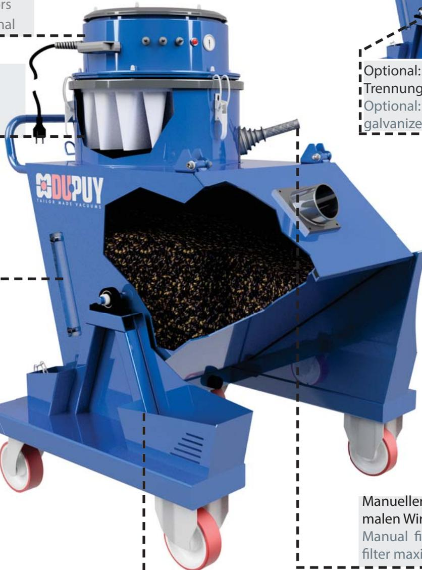
Manueller Filterrüttler für maximalen Wirkungsgrad
